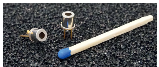
Miniaturisierte IR-Strahler im TO46-Gehäuse
